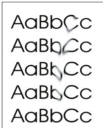
Manchas de tóner
